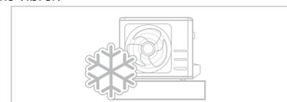
✓ Lorsque des chutes de neige sont prévues, prenez les mesures nécessaires pour éviter l'accumulation de glace et l'endommagement de la bobine.
