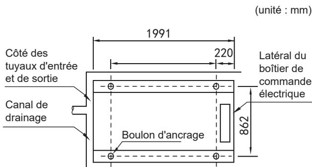
III.6-6 Vue du dessus du schéma des dimensions de l'installation MC-SU75-RN8L-B
