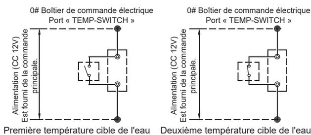
III. 8-22 Câblage du port électrique faible « TEMP-SWITCH »
