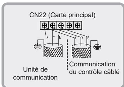
Comme indiqué dans la figure ci-dessous, pour MC-SU90-RN8L-B et MC-SU180-RN8L-B : le fil de signal de communication de l'unité est connecté au bornier XT2 à 5(X), 6(Y) et 7(E), et le fil de signal du contrôleur câblé est connecté à 8(X), 9(Y) et 10(E) à l'intérieur du boîtier de commande électrique. Pour un câblage spécifique, voir le chapitre 8.4.14.
