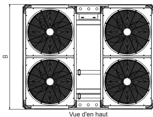
III. 6-2 Dimensions de contours du modèle MC-SU180-RN8L-B
