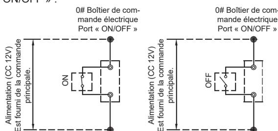
III. 8-21-1 Câblage du port électrique faible « ON/OFF »
