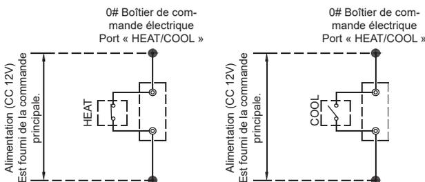
III. 8-21-2 Câblage du port électrique faible « HEAT/COOL »
