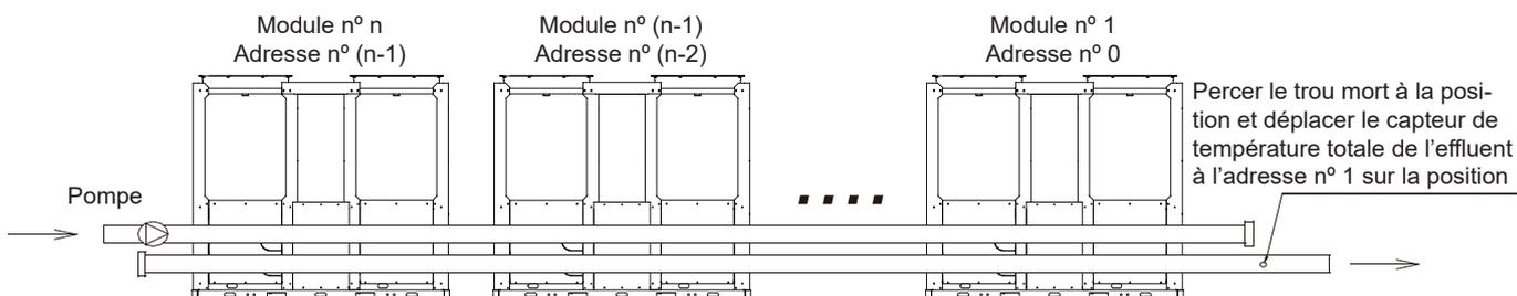
III. 8-32 Installation du module multiple (pas plus de 8 modules) MC-SU180-RN8L-B
