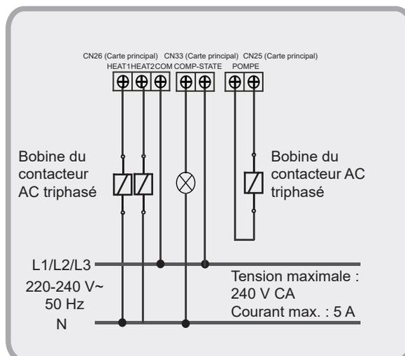
III. 8-20 Câblage de la pompe à eau et du chauffage auxiliaire de la canalisation et du voyant de CA de l'état du compresseur (MC-SU90-RN8L-B et MC-SU180-RN8L-B)
