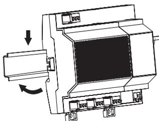
Encliqueter le produit sur le rail de guidage
