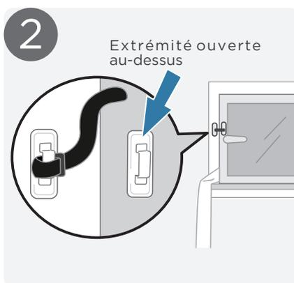
Faites passer la fermeture auto-agrippante à travers le deuxième support en plastique, sur le montant de la fenêtre.
