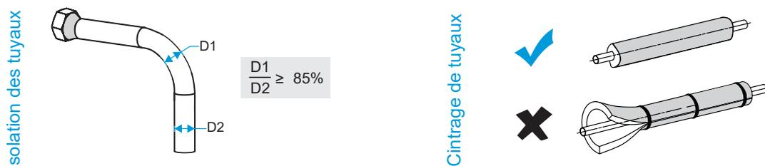
Remarque : D1 est le diamètre minimum et D2 est le diamètre nominal.
