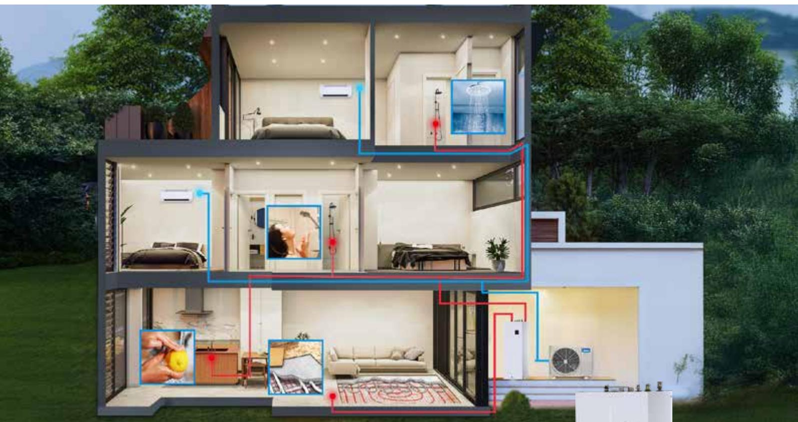
Le système ATOM T de Midea est une solution hybride qui combine le VRF avec le chauffage et la production d'ECS grâce à l'eau chaude. Il peut propulser de l'eau jusqu'à 60°C, même avec des températures extérieures de 5°C, offrant un chauffage efficace via des radiateurs, des ventilo-convecteurs et un plancher chauffant.
