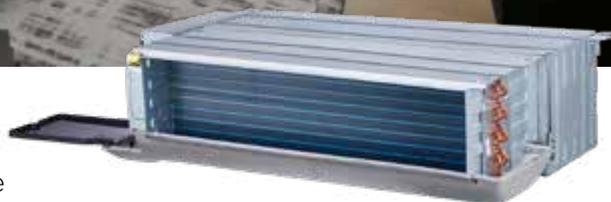
Unités à conduits basse pression pour installation horizontale à 2 tubes. Structure en tôle galvanisée avec batterie à eau à 3 rangées et filtre à air métallique. Version équipée de sorties modbus et XYE avec possibilité de connecter n'importe quelle commande du marché avec entrée pour la gestion des vitesses du ventilateur (H/M/L).
