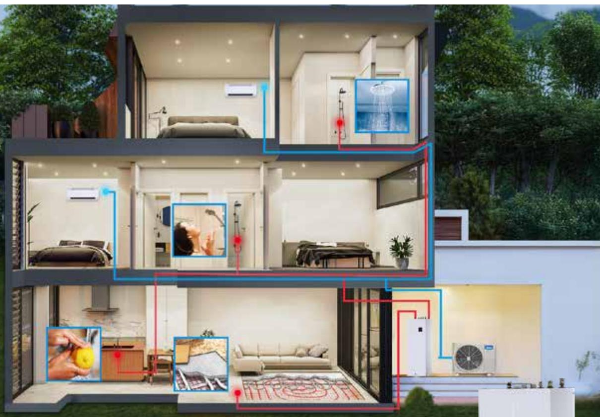
Le système ATOM T de Midea est une solution hybride qui combine le VRF avec le chauffage et la production d'ECS grâce à l'eau chaude. Il peut propulser de l'eau jusqu'à 60°C, même avec des températures extérieures de 5°C, offrant un chauffage efficace via des radiateurs, des ventilo-convecteurs et un plancher chauffant.
