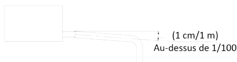
Illustration 3-6.1 : Exigences d'inclinaison minimum de la tuyauterie d'évacuation
