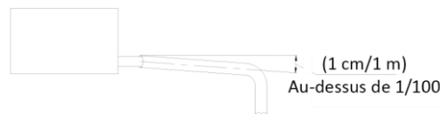
Illustration 3-6.1 : Exigences d'inclinaison minimum de la tuyauterie d'évacuation
