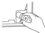
Pour éviter les fuites, vous devez boucher l'orifice de vidange non utilisé à l'aide du bouchon en caoutchouc fourni.
